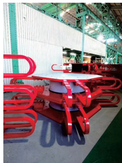
写真-3 免振装置
