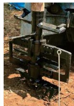
写真-2 掘削攪拌翼
