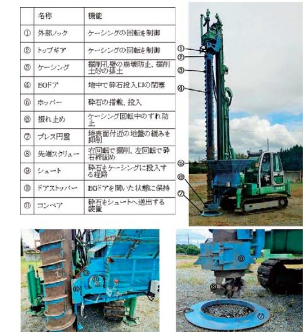
写真-1 施工設備の概要
