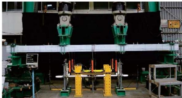
写真-1 曲げ性能確認試験 試験状況
