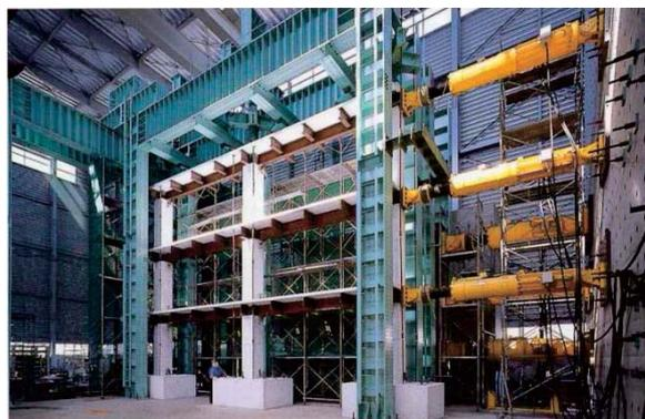
写真-1 実大規模の架構実験（3層2スパン）
