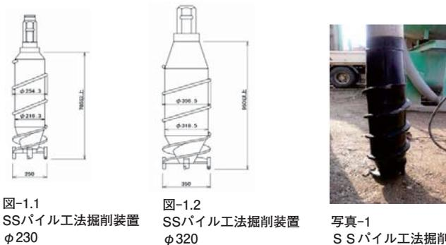
図-1.1 SSパイル工法掘削装置 φ230
