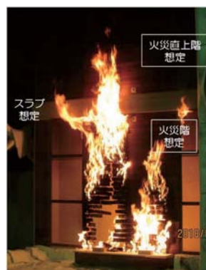
写真-13 床スラブあり
