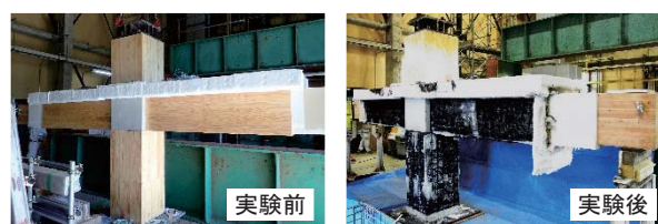
写真-6 木柱・梁・PCa接合部載荷加熱実験
