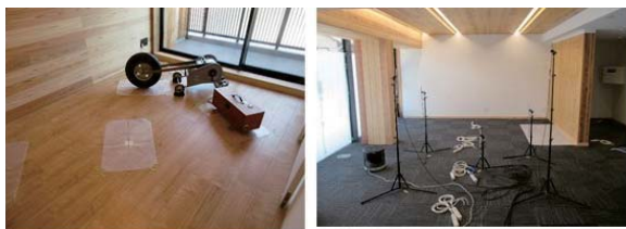
写真-5 RC-CLT合成床版 床遮音性能試験状況
