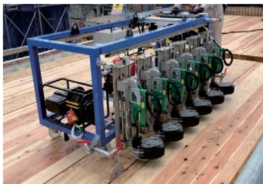
写真-30 CLT床版ビス打ち機
