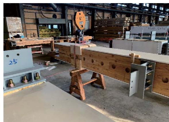
写真-17 スリム耐火ウッド®梁部材製作状況
