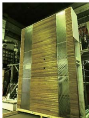
写真-11 木質外装実大試験体
