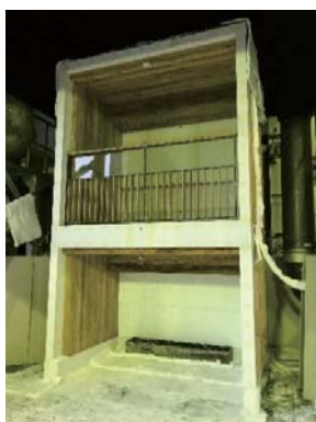
写真-9 バルコニー試験体
