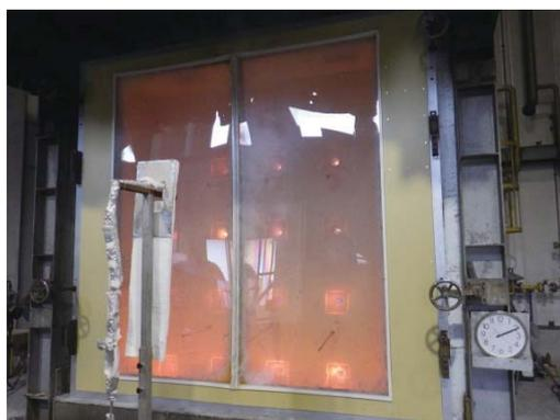
写真-2.8.2 防火設備の試験状況
