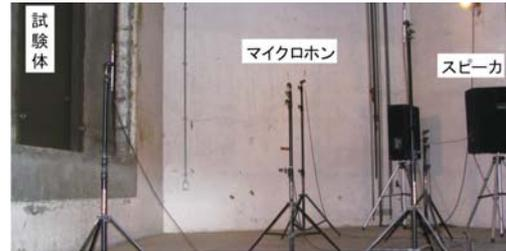
写真-2.9.1 遮音性試験の状況（音源室側）
