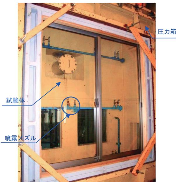
写真-2.2.1 水密性試験装置（小型圧力箱）
