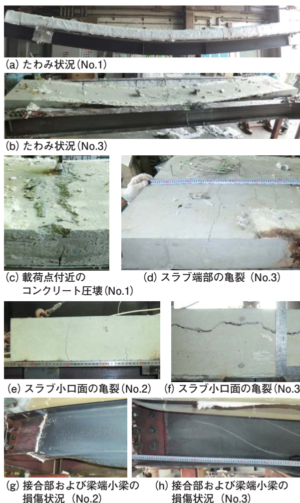
写真-1 実験後の試験体損傷状況
