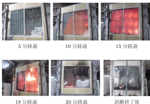
写真-6 BIPVモジュールにおける発電状態での防耐火試験 20), 21)
