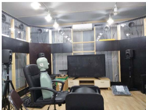
写真-10 心理音響評価用の聴感実験室（FILK）
