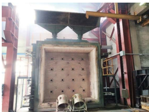
写真-8 試験体入れ換え中の大型壁炉（FILK）
