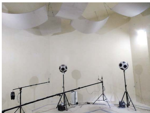
写真-9 遮音試験用の残響室内（FILK）
