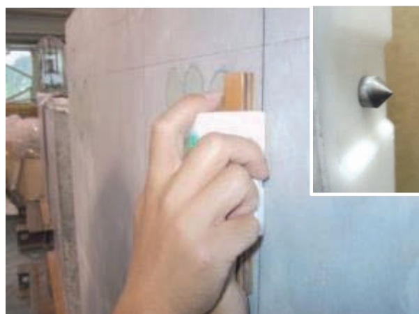
写真-3 引っかけ傷を加えている状況と 引っかけ試験器先端
