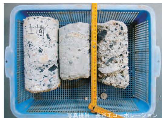
写真-5 コアの写真（採取コアの一部）
