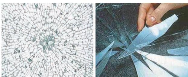
写真-3 強化ガラス破損状態 写真-4 フロートガラス破損状態<sup>5)</sup>
