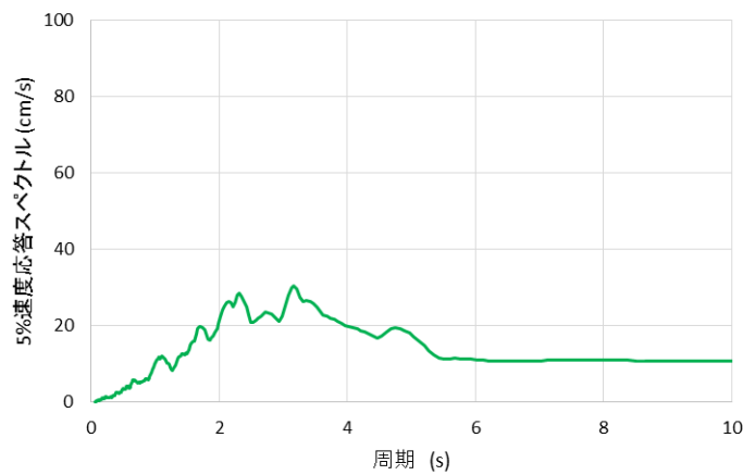
図 1.2 地表面（線形）サイト波の上下動の速度応答スペクトル
