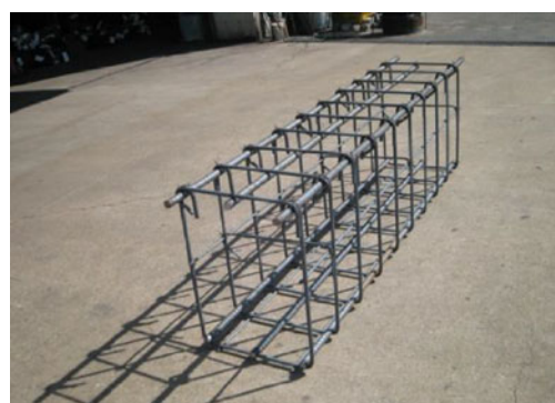
写真-2 現場組み立て 鉄筋スポット先組工法ユニット
