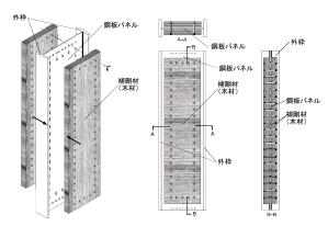
図-1 木補剛制振間柱の構成
