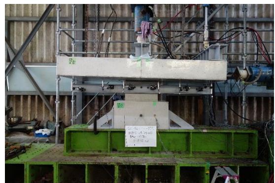
写真-1 回転性能確認試験状況
