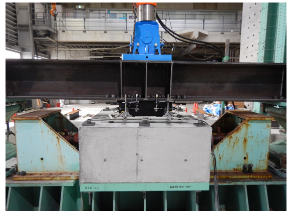
写真-1 頭付きスタッドの実験状況
