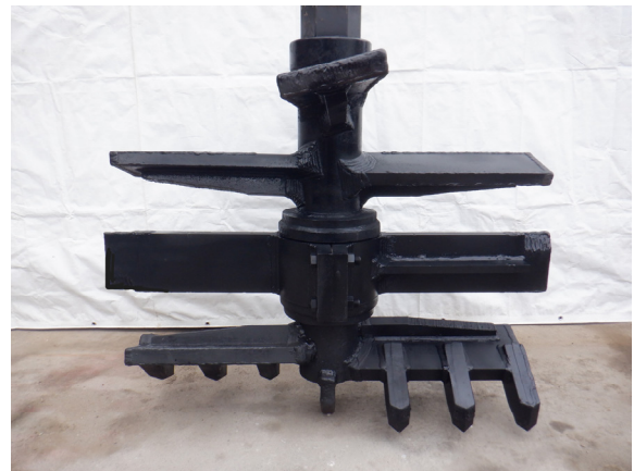
写真-1 掘削攪拌ヘッドの例 (φ1000)
