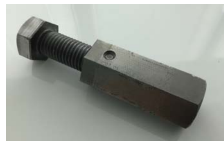
写真1 加締めを行ったインサート
