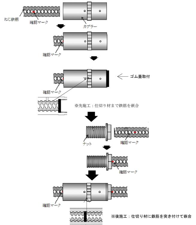
図 1 自在ジョイント打継継手概要
