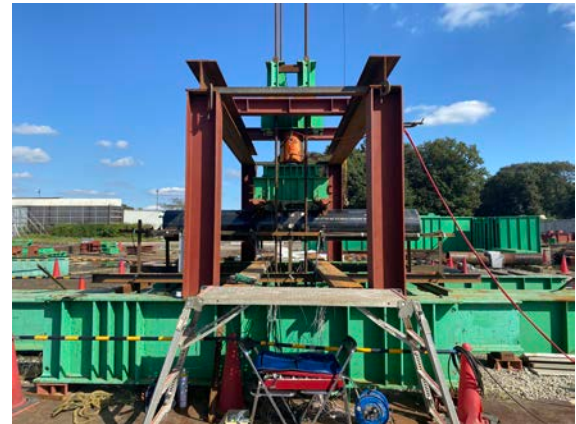
写真1 4点曲げ試験 試験装置全景
