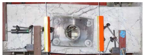
(b) 鋼板補強試験体
