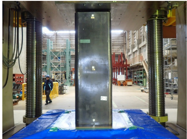
写真-1 JBCR325P の短柱圧縮試験の様子
