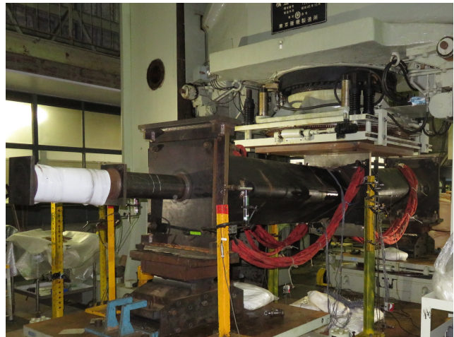
写真-2 JBCR325P の曲げ試験の様子
