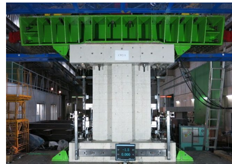
図2 柱部材実験状況
