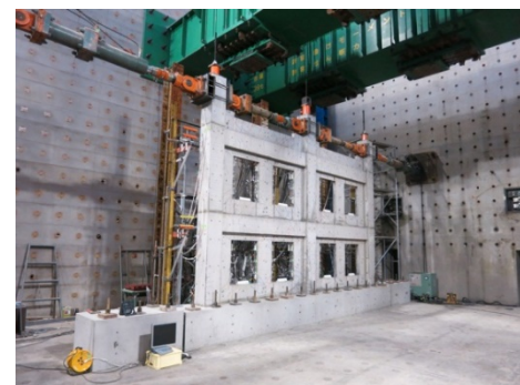
図3 2層2スパン架構実験状況
