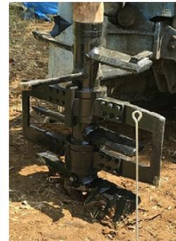
掘削攪拌翼写真
