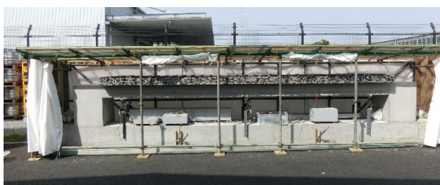
写真2 長期載荷試験 試験状況
