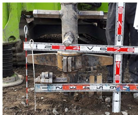
写真-1 攪拌混合装置
