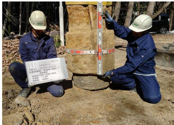
写真-2 築造した改良体の一例
