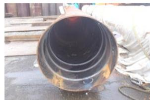
写真1 リング状突起付き鋼管
