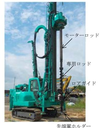
図2 施工機械の概要
