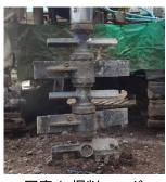
写真 1 掘削ヘッド 写真 2 芯部築造用先端ビット
