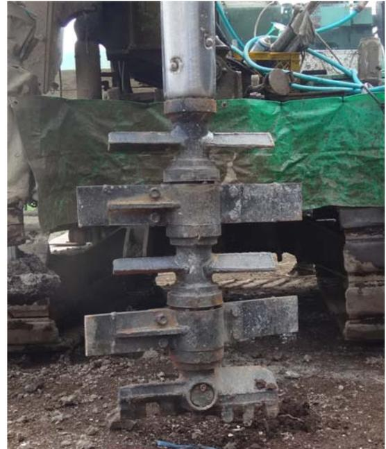
写真-1 掘削攪拌ヘッド
