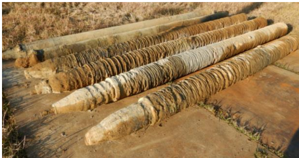
図1 引き抜いた柱体の状況 (手前側4本PPⅢ、奥側2本PPⅡ)
