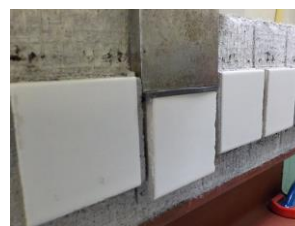
写真-3 せん断接着試験時にタイルを約10mm押し込んだ状況(剥落していない)
