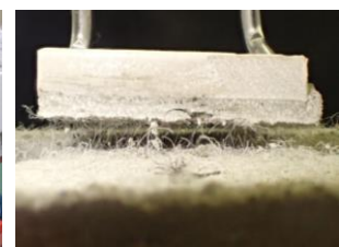
写真-4 せん断接着試験後のタイルを持ち上げた状況(まだ繊維が繋がっている)
