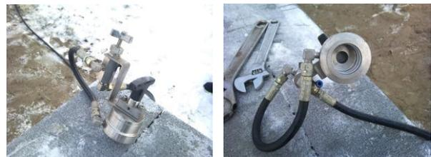
写真-2 加圧注水装置
