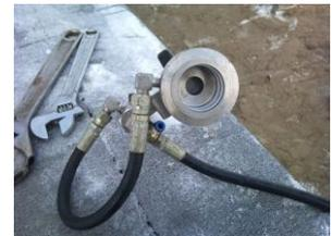
写真-3 拡張鋼管の加圧装置
