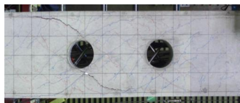
開孔間隔=開孔径×3、X形補強筋なし
