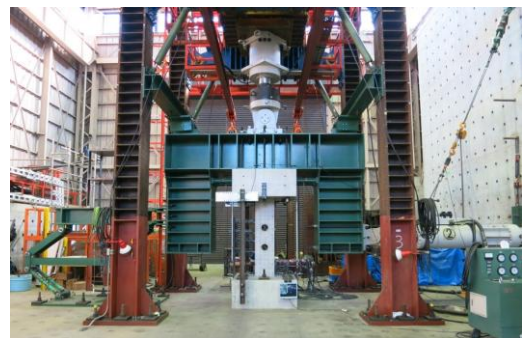
有孔梁試験体 加力状況
