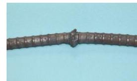
写真 1 溶接継手
