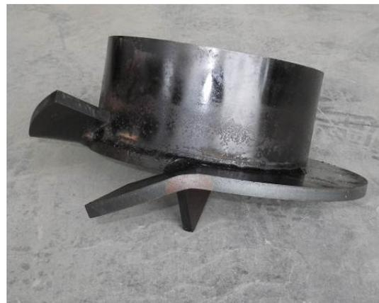
写真1 先端翼の形状
