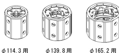
S Bロック継手部品図 (3サイズ)
