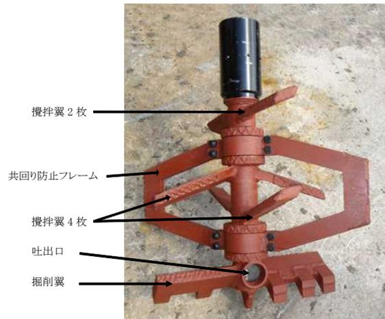
写真1 掘削攪拌機
