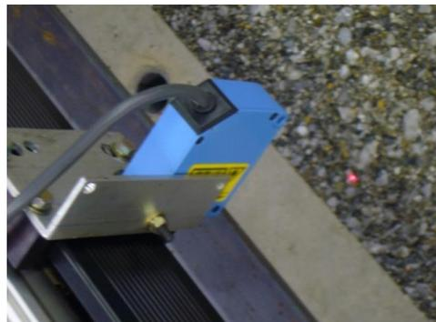
レーザー変位計による計測状況
