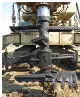
写真-1 SSコラム工法攪拌翼
