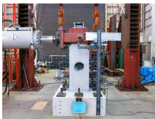
有孔梁試験体 加力状況
