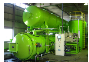
写真-4 加圧注入木材保存処理
