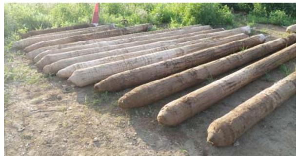
図1 引き抜いた柱体の状況
