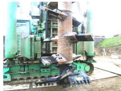
写真.1 攪拌混合装置
