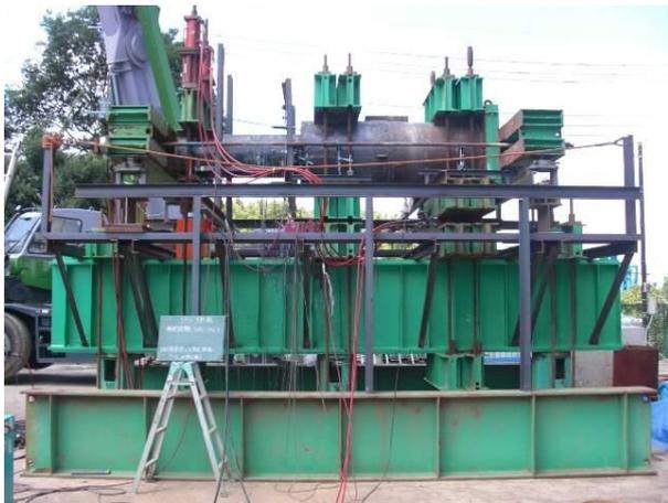
写真1 曲げせん断試験 試験装置全景
