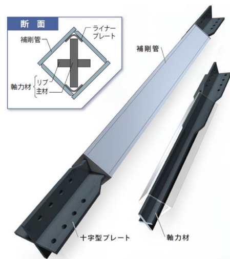
図1 ハーフ十字ブレースダンパー
