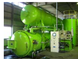
写真4 加圧注入木材保存処理
