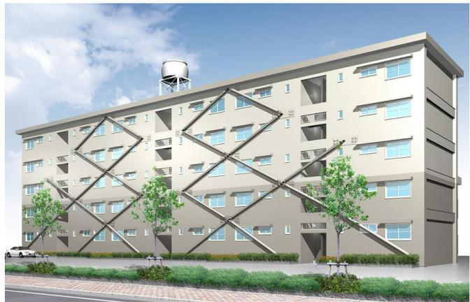
図1 二重鋼管ブレース外付け制振補強工法
