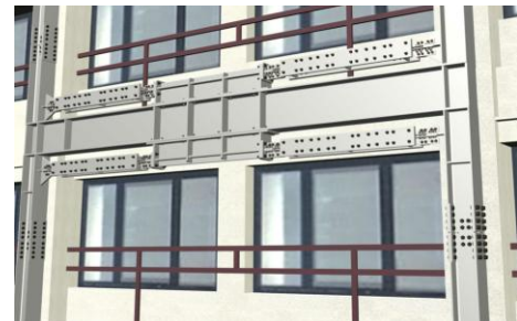
図 1-3 「外付け工法」施工イメージ図
