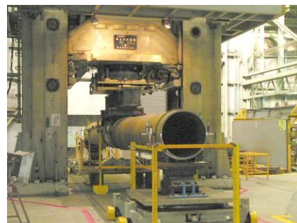
図-3 曲げ実験状況
